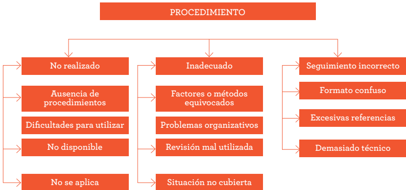
FIGURA 4. Factores asociados con fallas relacionadas con el procedimiento
