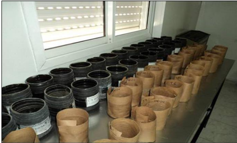
Imagen 1: elaboración de ovitrampas con frascos meleros pintados de negro y papel misionero.
